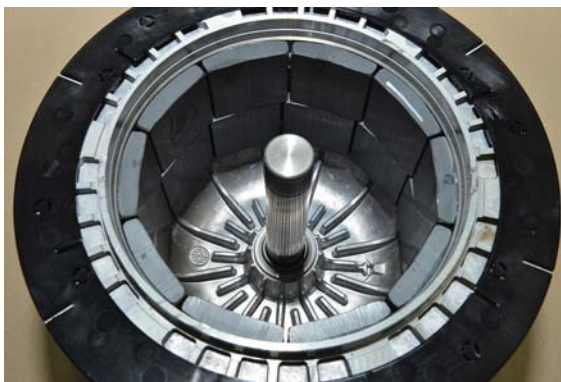
Rotor z hliníkového tlakového odlitku s umělohmotnou deskou (není znázorněna) na prstenci
