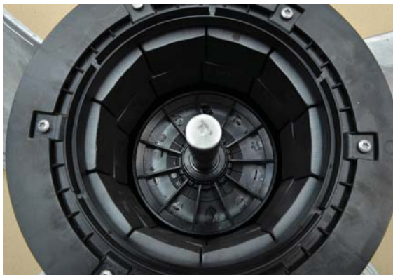
Ocelový rotor s umělohmotným chladicím kolem
